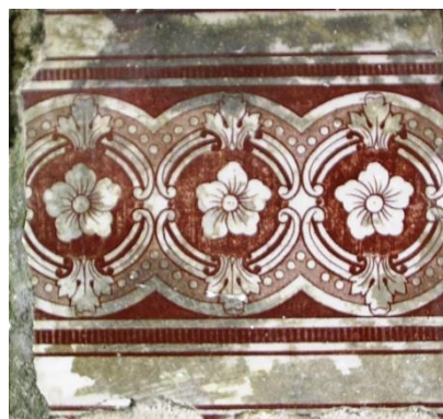
Azulejo fortemente colonizado por microrganismos, no interface vidro-chacota
